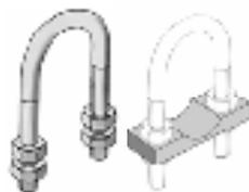
Rundstahlbügel DIN 3570
